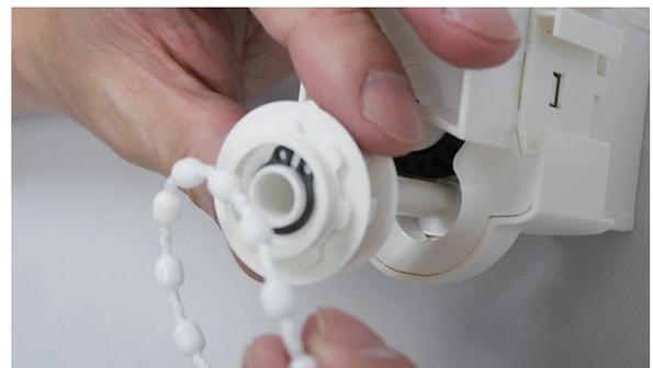
④ ②→①の逆手順で、コントロールユニットをヘッドボックスに取り付けてください。コントロールユニットにシャフトをはめ込む際に穴の位置がずれている場合は、チェーンを引いて合せながらはめ込んでください。
