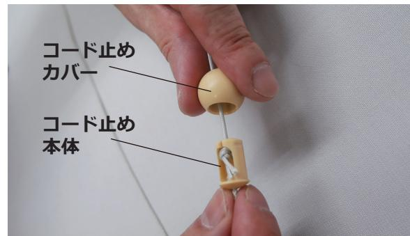
② コード止め本体から、昇降（調光）コードを抜き取り、長さを調整して余分なコードを切り、コードを結び再度本体に納めてください。（※その際、昇降または調光操作時に片上がりが無いよう結んでください。）
