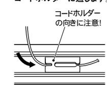
コードホルダーの向きに注意して(上図を参照)昇降コードを通してください。この時、昇降コードの通す方向を間違えてしまうと故障の原因となります。
