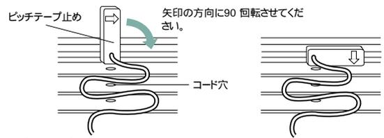
ピッチテープ止めをヘッドボックスにコード穴の位置に合わせてセットし、矢印の方向に90度回転させて固定させてください。この時、逆の方向に回転させるとピッチテープ止めが破損しますのでご注意ください。
