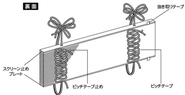
ご注意: 取替え作業の途中で「ステコード」を抜き取りますので、その段階まではステコードを抜いてしまわないようにご注意ください。
