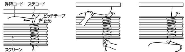
新しいスクリーンのステコードの結びを解いて裏返しに置き、ピッチテープ止め側のステコードのループに昇降コードを通します。
