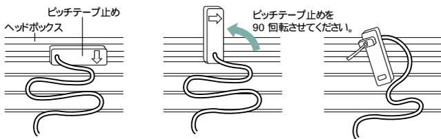
ピッチテープ止めを90度回転させて、ヘッドボックスから取りはずしてください。
