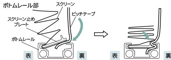
ポトムレールの中へピッチテープの端部と一緒にスクリーン止めプレートを入れてください。初めに商品の表側に斜めに差し込み、次に商品の裏側の方向へ収めてください。
