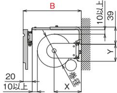
巻径により、バランスブラケットの種類とブラケットの取付位置が異なりますので、下記を参照してB寸法とY寸法を確認ください。
