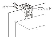
ヘッドボックスをブラケット手前のツメに引っ掛けてから、奥へ 押し上げるようにカチッと押し込んでください。
