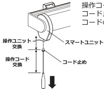
操作コードの交換は、コード止めより下部のコードが対象になります。コード止めより上部のコード（巻かれる箇所）が破損した場合は、操作コードのみの取替えはできません。操作ユニットごとの交換になります。
