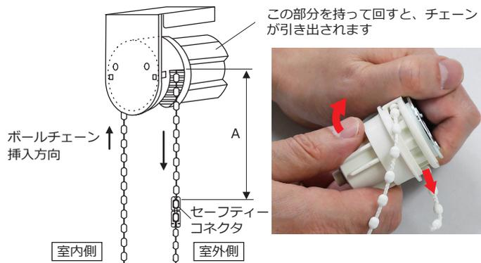
⑤ 逆巻き防止コネクタを取付けてください。生地を商品高さ分全部引き出した状態で、ホイールカバー入口にあるボールチェーンに逆巻き防止コネクタ(ボールチェーンコネクターと同部品)を取付けてください。
