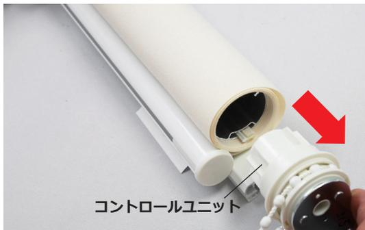
③ コネクター部品の上部のチェーンをラジオペンチ等ではさみ、コネクターから玉の部分を抜き出すようにして外してください。
