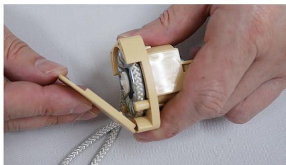
③ プーリーを回しながら、取り替える操作コードを抜き取り、新しい操作コードに差し替えてください。
