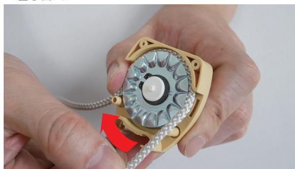
④ 操作コードを写真のようにセットし、②→①の逆手順で操作ユニットをヘッドボックスに固定してください。
