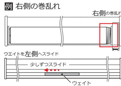
③ 巻乱れが調整できた位置で、ウェイトのネジを締めてウェイトを固定します。
