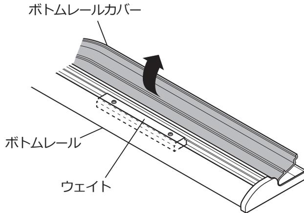
② ウェイトを固定しているネジを緩め、スクリーンの巻乱れが生じている方と反対方向へウェイトをスライドさせてください。スライド量により巻乱れの微調整が可能です。 少しずつ「スライド→昇降確認」を行い巻乱れのでない状態に調整をしてください。
