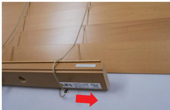
⑦ 昇降コードをボトムレール、コードクリップ（突起側から通す。）の順番に長さを調整しながら通し、二重結びで止めます。
