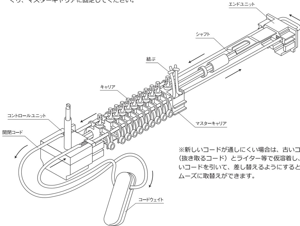
※新しいコードが通しにくい場合は、古いコード（抜き取るコード）とライター等で仮溶着し、古いコードを引いて、差し替えるようにするとスムーズに取替えができます。
