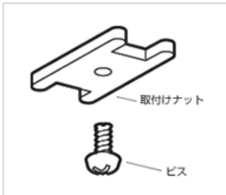
オプション部品のカーテンレール用取付けナットとビスを使用します。
