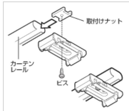
取付けナットをカーテンレールに差し込み、ブラケットをビスでしっかりと固定します。
